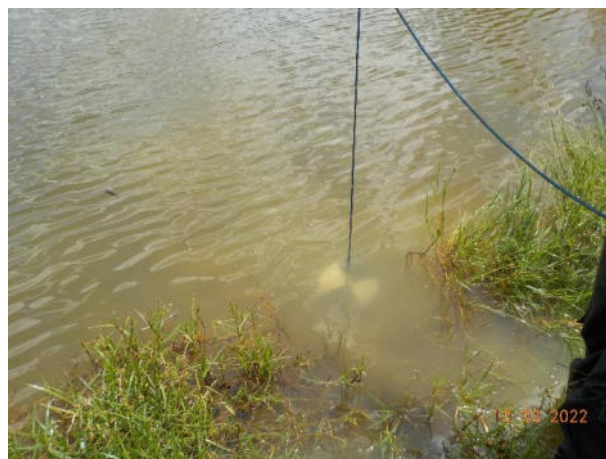
Foto 4 – Medição de transparência com disco de Secchi. (Data: 10/03/2022).
